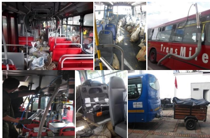
Figura 3 - Instrumentación de Vehículos. Fuente Convenio 015 SDA-UNAL
